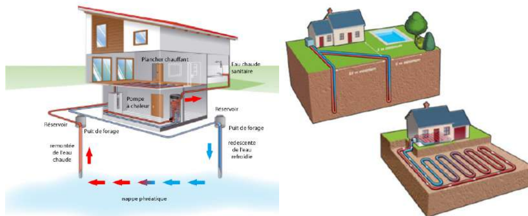
Figure 86 : Schéma de principe des différents types de géothermie de surface : géothermie sur aquifère ou géothermie sèche verticale ou horizontale.
